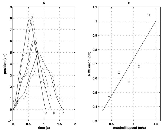
Figure 6. POSITION TRACKING (TEACH-AND-REPLAY) DATA. A) SOLID LINE: ONE CYCLE OF DESIRED SIDE-TO-SIDE TRAJECTORY, DASHED LINE: ACTUAL SIDE-TO-SIDE TRAJECTORY WHEN PAM MOVED A 100-LB PUNCHING BAG, a: 0.45 M/S (1 MPH), b: 0.89 M/S (2 MPH), c: 1.34 M/S (3 MPH). B) ROOT-MEAN-SQUARE TRACKING ERROR VERSUS THE TREADMILL SPEED AT WHICH THE DESIRED TRAJECTORY WAS RECORDED.
